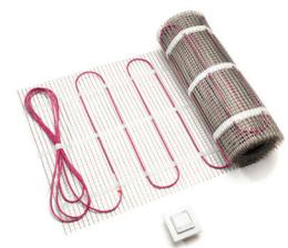
Может быть использована для основного отопления помещения, а также для комфортного, когда в помещении есть центральное отопление, например, радиаторное. Система состоит из нагревательного кабеля или мата (мат – это кабель, закрепленный на монтажной сетке) и терморегулятора.
