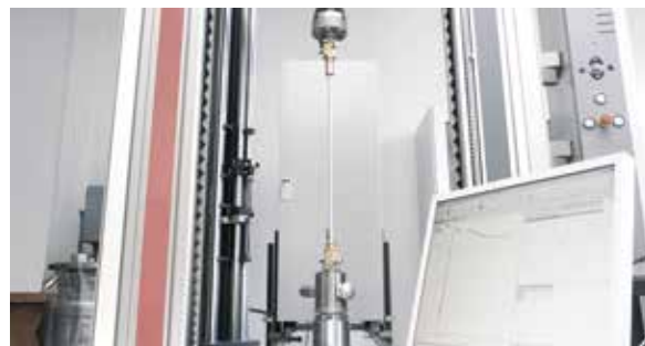
Рис. 3 Ход испытания на растяжение
