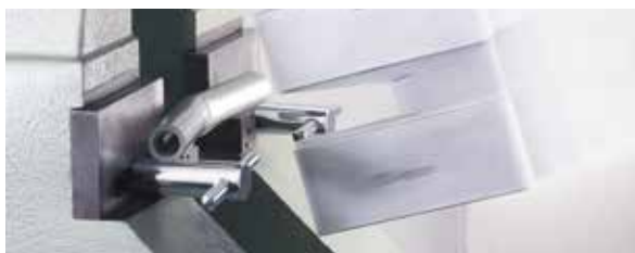
Рис. 2 Универсальная труба RAUTITAN flex в установке по испытанию ударной вязкости
