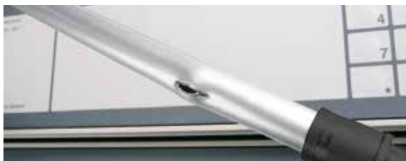
Рис. 1 Результаты испытания прочности на разрыв давлением. Испытуемый продукт – универсальная труба RAUTITAN flex
